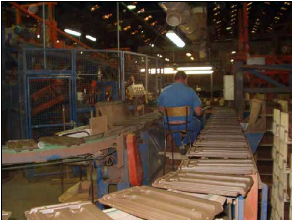
Le sonneur frappe chaque tuile et reconnaît à l'oreille si elle est fêlée
